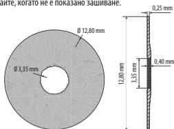
Фиг. 1: Изглед отпред на ARTIFICIAL/IRIS и напречно сечение с размери на моделите с влакна и без влакна
